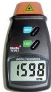
បរិក្ខារវាស់ល្បឿនជុំដោយប្រើកាំរស្មីឡាហ្វែរ
